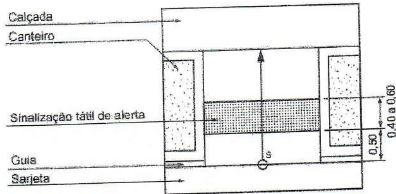
Figura 2: Rebaixamento de calçada com faixa de serviço/canteiro.
